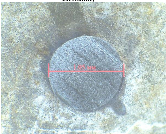
Рисунок 2. Образец после пассивации поверхности
