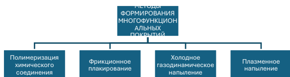
Рис. 1. Разрабатываемые методы формирования многофункциональных покрытий
