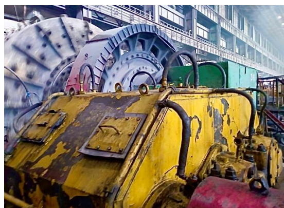
Рис. 1. Общий вид мельницы мокрого самоизмельчения ММС-70×23 «Гидрофол». Производитель АО «Тяжмаш», Россия, Самарская область
