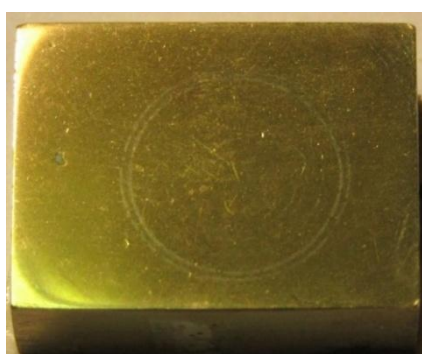
Рис. 3. Дорожки трения на круглом и прямоугольном образцах после испытаний
