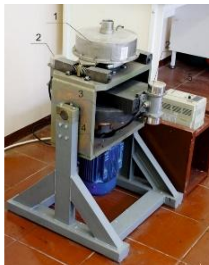
Рис. 1. Волновой дезинтегратор 1- реактор; 2 – двигатели крутильных колебаний; 3 – упругий элемент; 4 –привод вращения; 5 – частотный преобразователь.
