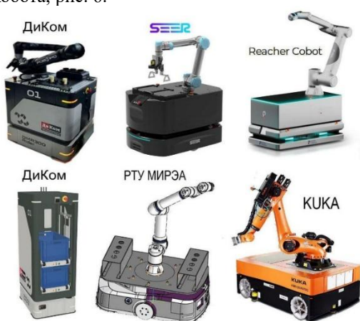
Рис. 6. Мобильные транспортные тележки со встроенными коботами
