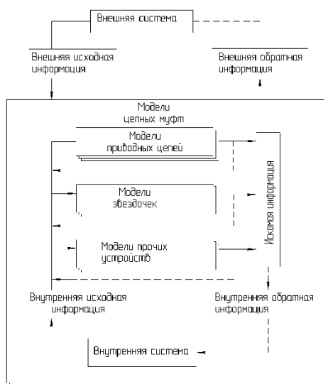
Рис. 1. Структура математической модели цепной муфты
