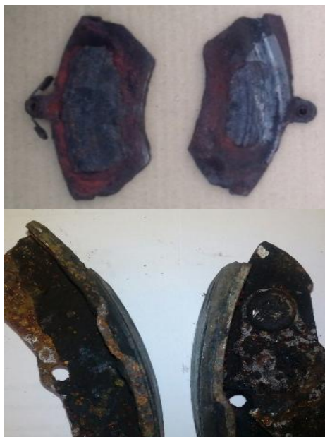
Рис. 2. Пример видов разрушения и износа тормозных колодок
