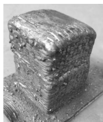
Рис. 2. Фотография заготовки для режима охлаждения с расходом воды – 5 л/мин
