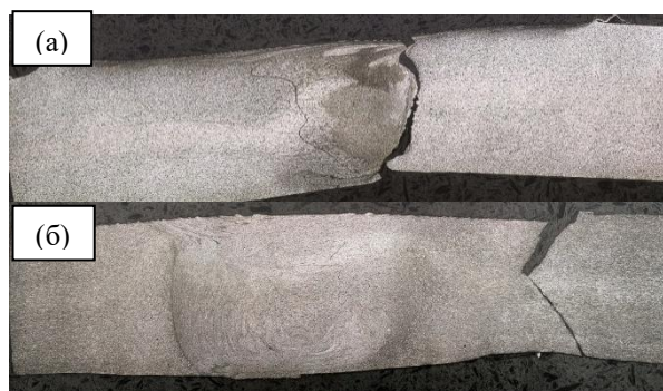
Рис.3. Разрушение сварного соединения сплава АМг5: (а) вдоль комплексного дефекта; (б) по основному металлу в бездефектном сварном соединении, оптическая металлография
