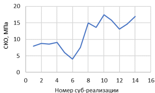
Рис. 1. Временная зависимость среднего квадратического отклонения. Суб-реализация №8 соответствует переходу на большую скорость.
