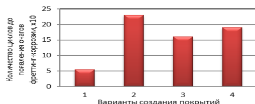
Рис. 2. Износостойкость разъемных соединений: 1 – серийный образец; 2 – газотермическое и химическое покрытие деталей; 3 – покрытие ФАБО; 4 – восстановленный серийный образец
