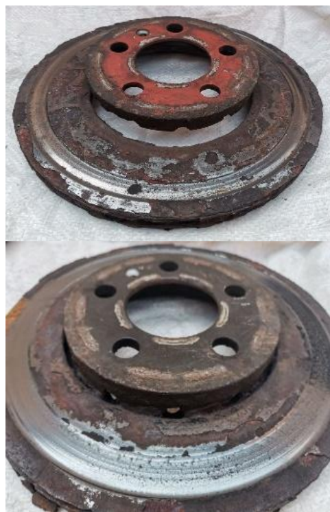
Рис. 1. Пример видов разрушения и износа элементов тормозного диска
