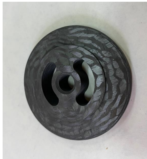
Рис. 3. Распределитель из углеродного композита
