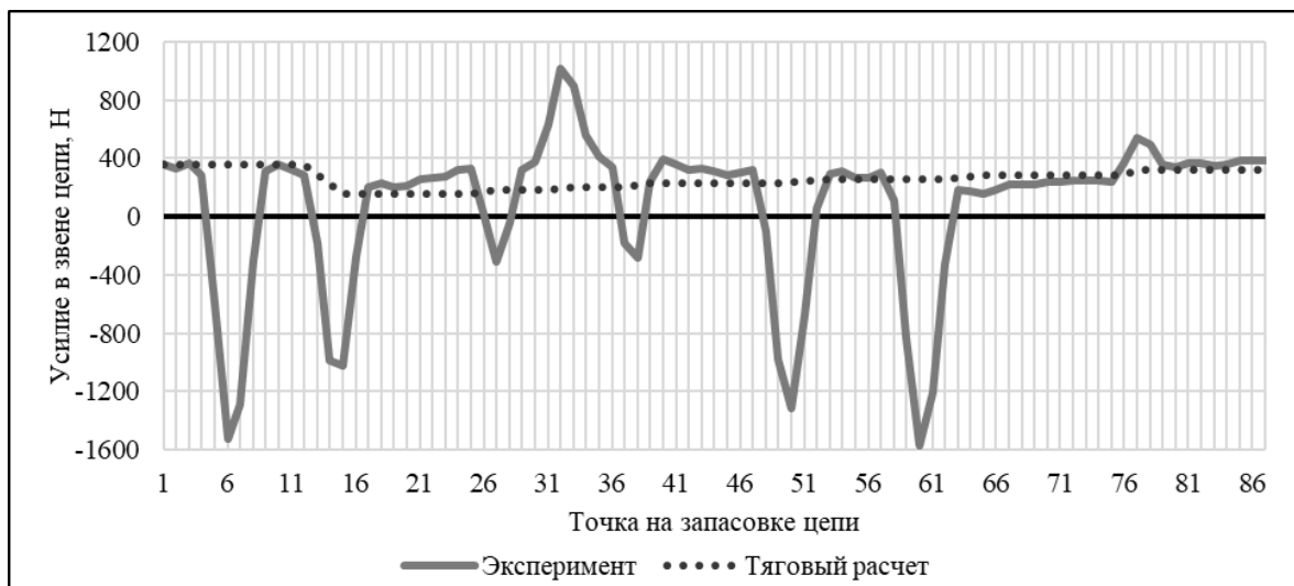
Рис. 4. График сравнения тягового расчета с экспериментом
