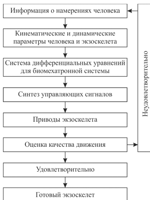
Рис. 1. Схема синтеза экзоскелета
