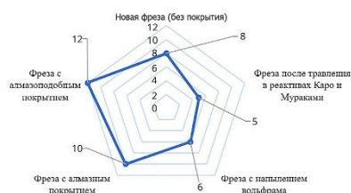
Рис. 2. Схема измерения радиусов (μм) режущей кромки фрезы WC+6%Co без покрытия и с покрытием
