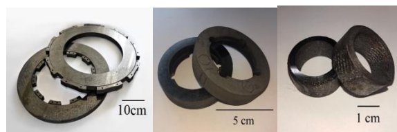
Рис. 1. Кольцевые образцы углеродного волокнистого композита для разных испытательных машин.
