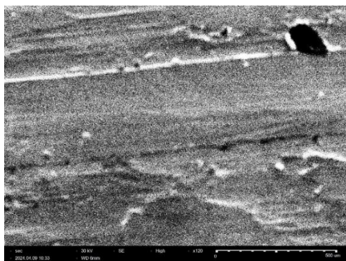
Рис. 4. Микроструктура поверхности вкладыша подшипника скольжения мельницы мокрого самоизмельчения ММС-70×23 «Гидрофол»
