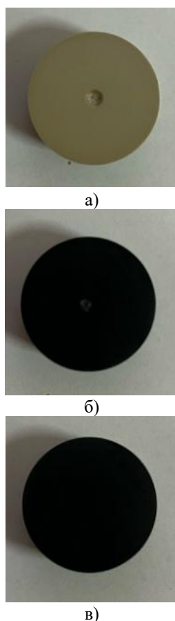
Рис. 1. Полимеры и композиты на основе ПЭК: (а) ZX-324, (б) ZX-324 SW, (в) 3- ZX-324 UG30
